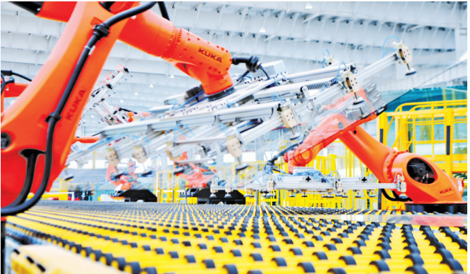
贵州海生玻璃有限公司玻璃生产线的机械臂自动抓取玻璃原片。本报记者 朱金芳
