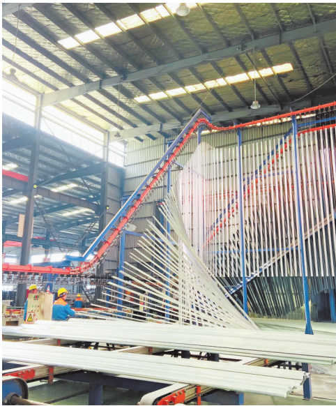
贵州十九度铝业立式喷涂生产线。
