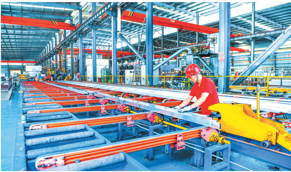
位于贵阳经开区的贵州贵材创新科技股份有限公司，是国家级专精特新“小巨人”企业。该公司以技术创新赋能产业升级，推动铝产业向高端化迈进。图为10月19日，工人在挤压车间生产线上开展铝型材挤压加工作业。
