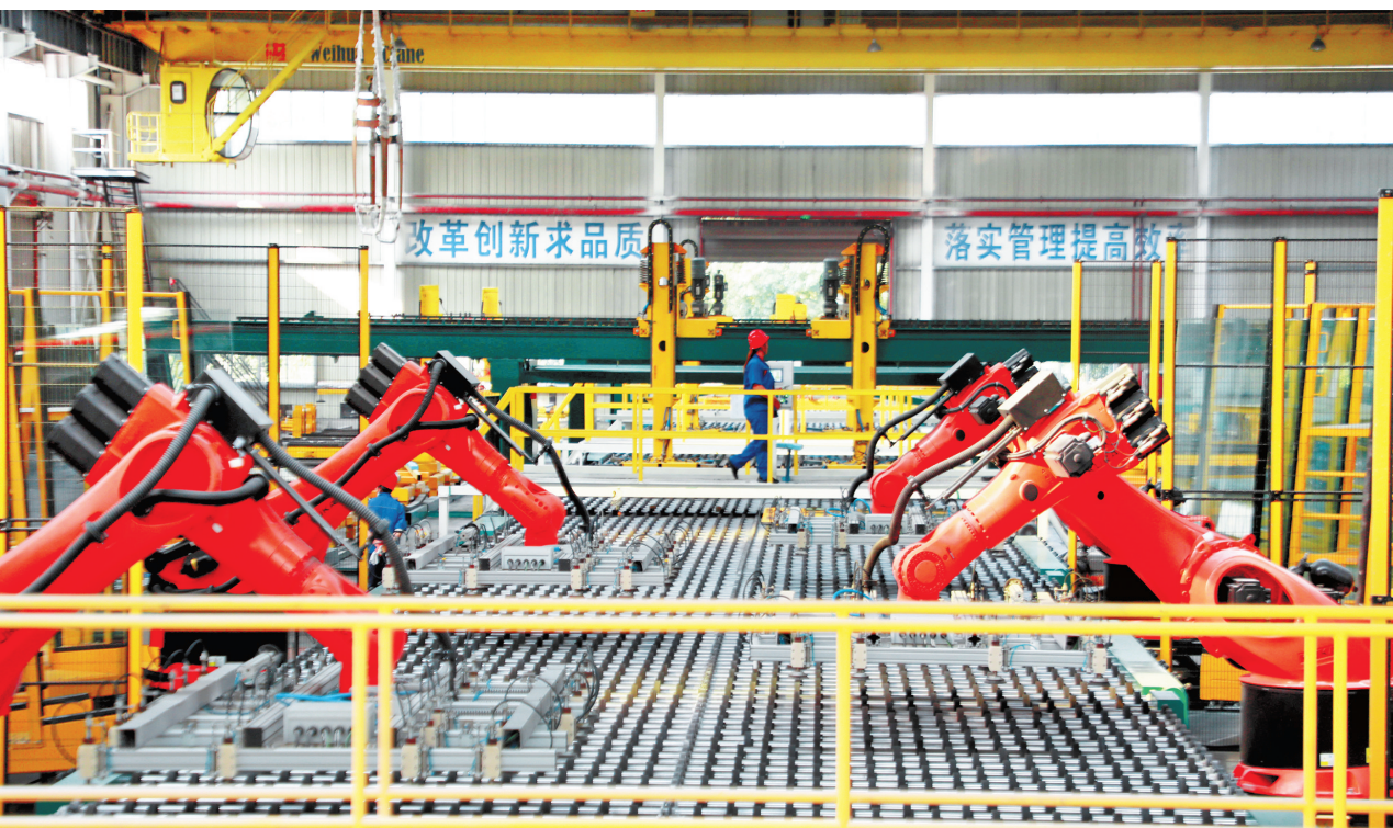
毕节明钧玻璃股份有限公司生产车间，智能化机械臂抓取玻璃。本报记者 汪瑞梁 摄
