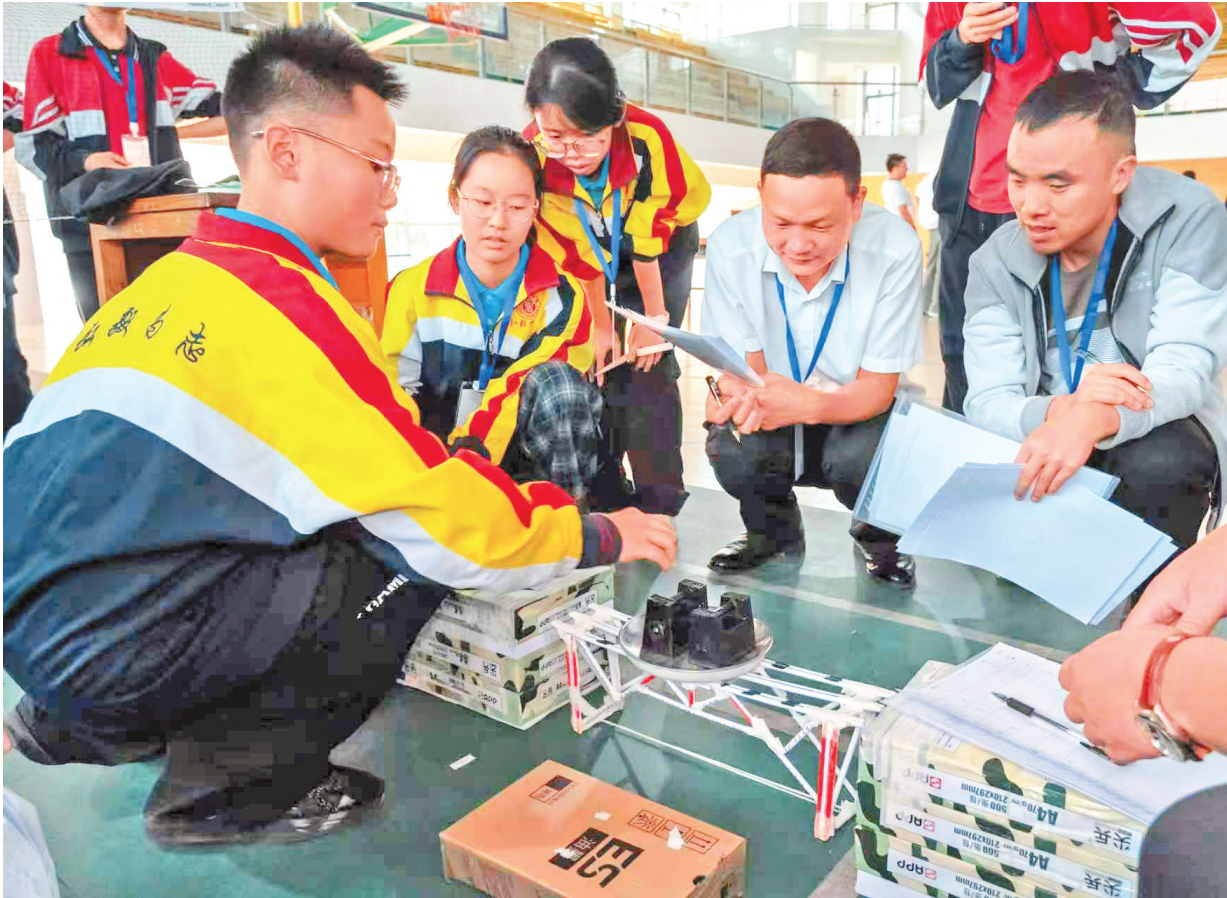
参赛同学用砝码测试纸桥的承载力。
