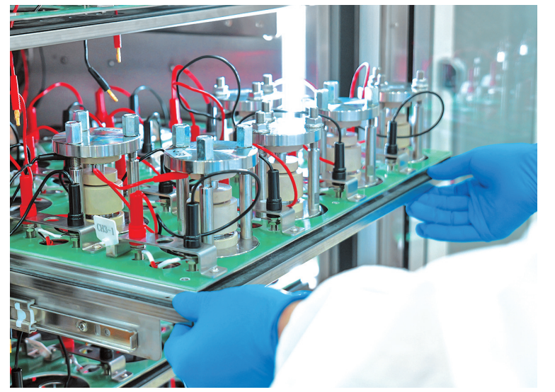
科研人员对模具电池进行组装及性能测试。
