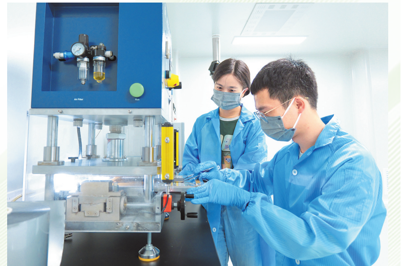
科研人员对固态电池进行关键材料模切。
