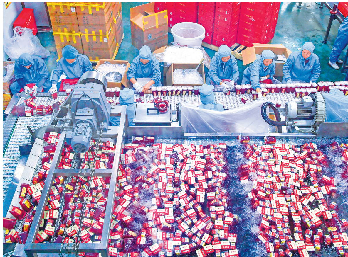
位于黔东南州惠水县的贵州成有王记善沃食品有限公司以生产创新为抓手，推动产业升级。企业实现鲜果清洗、灌装封口全流程自动化控制，引进国内先进低温杀菌技术，在保留杨梅原始风味的同时，有效延长产品保质期，提升品质稳定性。因为近日工人在生产线上作业。
