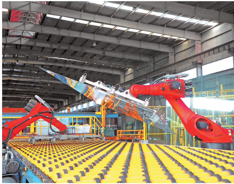
毕节明钧玻璃股份有限公司冷端车间，智能化机械臂精准抓取玻璃进行码垛。
