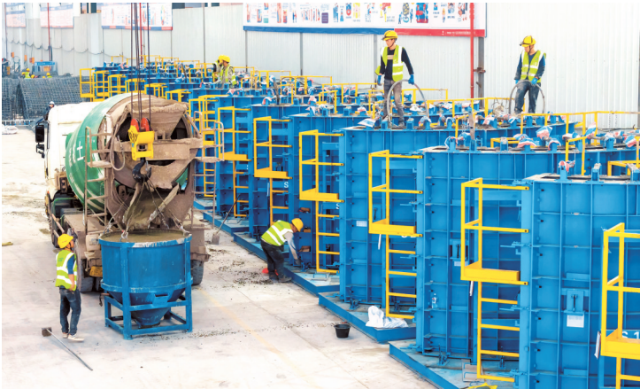
近日，黔东南州长顺县威远产业园内中水十五局（黔东南州）新能源公司的生产线上机器轰鸣，一片片大型风电混凝土塔筒正浇筑成型。这标志着贵州首次实现了风机塔架的本土化生产。贵州日报天眼新闻记者 龙永 摄
