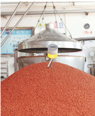
↑插入式分级温度传感器实时捕捉高粱堆的温度变化。 王茂 摄
