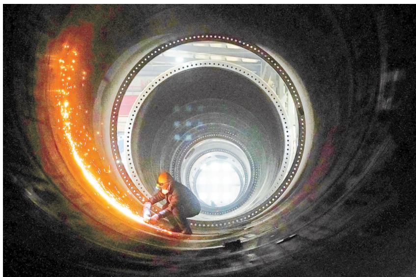
贵州保龙设备制造有限公司风电塔筒生产车间内，工人对塔筒焊接接口进行打磨。
