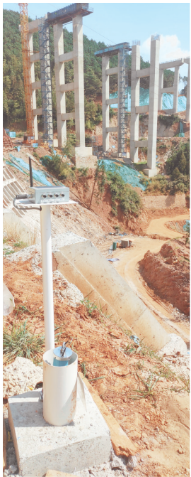
安盘高速上安装的全向位移计，能精准捕捉毫米级位移。（受访单位供图）
