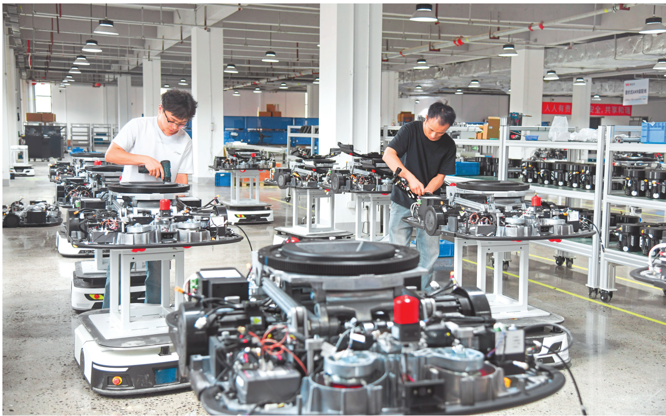
近日，贵安新区威迈尔科技有限公司技术人员正在组装智能移动机器人。据介绍，该智能移动机器人整体圆滑扁平，可自主完成导航、避障、对接等多种技术动作，还可以进行高负重搬运，主要运用在半导体、汽车、光伏、电池等工业生产领域。
