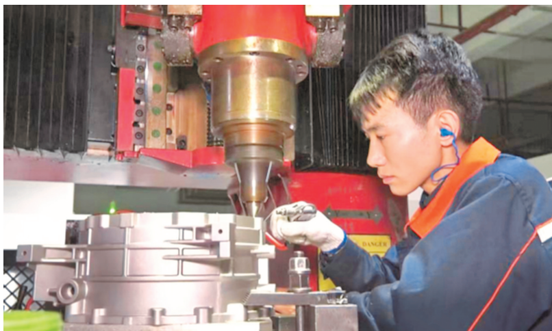
贵州蓝辉新材料有限公司生产车间内，工人进行新能源汽车电机壳搅拌摩擦焊环节生产。 通讯员 唐宇 摄
