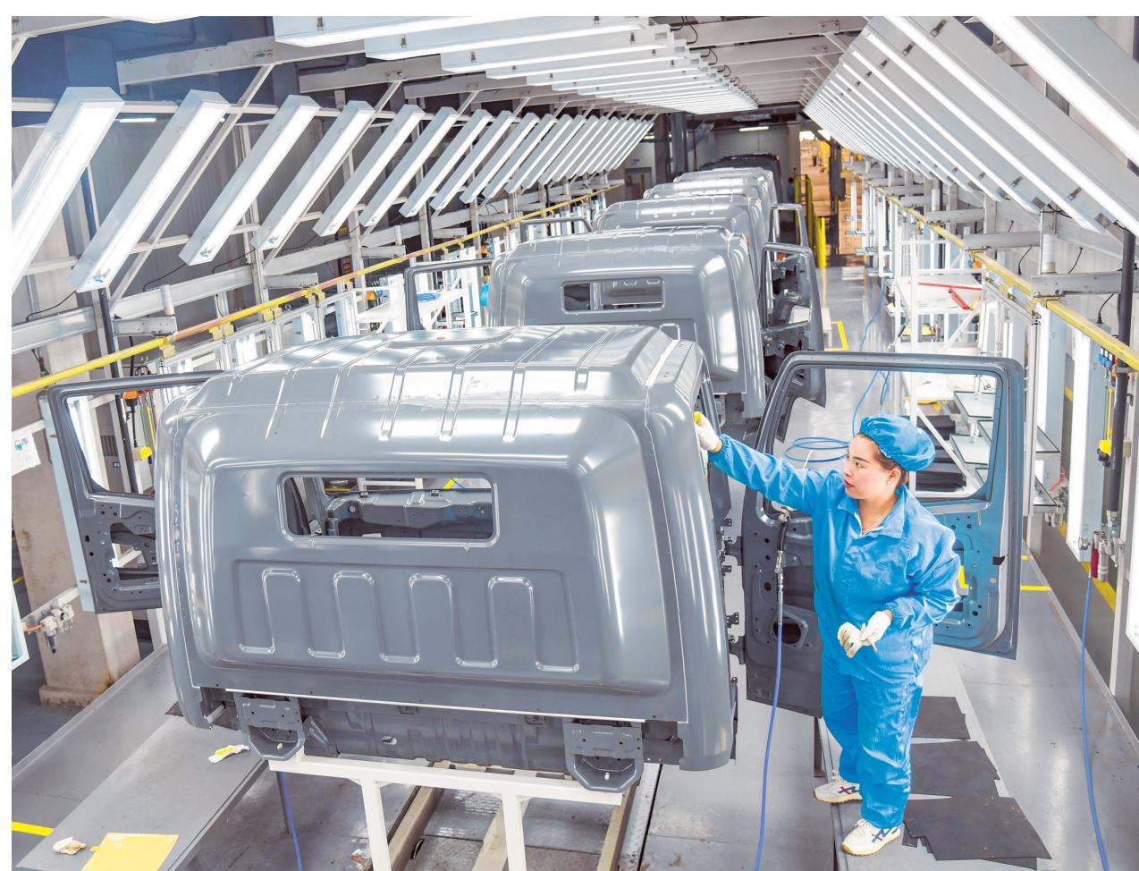
8月13日，在贵安新区贵州长江汽车有限公司涂装车间内，工人正实时监控机器人进行车身喷漆作业。
