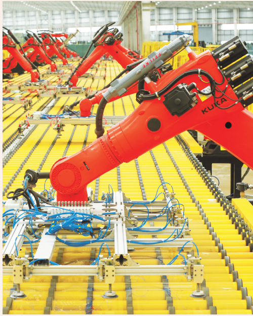
今年,贵州沪碧经济开发区规划建设优质玻璃产业园,加大技术研发投入,聚焦玻璃“智”造及深加工等核心业务,推进技术创新,不断增强产品核心竞争力。图为贵州黔玻永太新材料有限公司玻璃生产车间内,机械臂正在自动抓取玻璃原片进行码放。 王纯亮 摄
