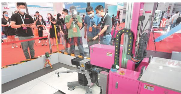
在2022世界机器人博览会“机器人+建筑”区域展示的一款地砖铺贴机器人。
