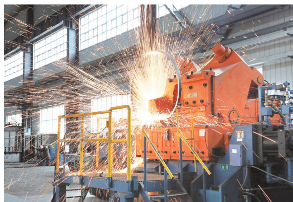
贵州安大公司引进闪光焊生产线。 赵金方 摄
