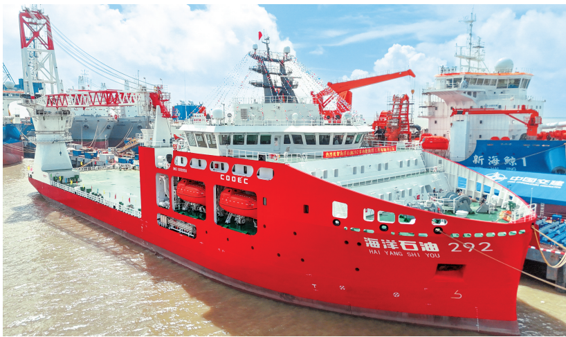
8月21日，我国自主研发新一代深水多功能海洋工程船“海洋石油292”在江苏南通完工交付。该船总长126米、型宽28米，排水量超17600吨，配备400吨级起重机、3000吨级卷盘及水下机器人等专用设备，可承担水下管缆安装、海底调查、运输保障等全流程海洋工程综合作业。
