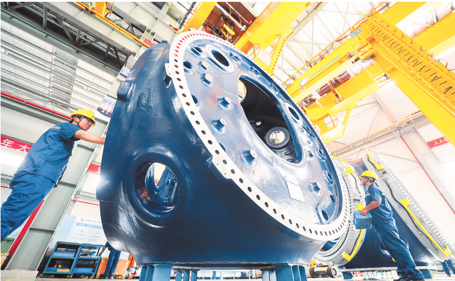
8月21日，由明阳智慧能源集团股份有限公司自研自制的明阳天启MCD5.0兆瓦超低风速风力发电机组，在黔东南州丹寨县金钟经开区正式下线。明阳智能针对西南地区超低风速、复杂气候特点定制了该机组，可适配山地超低风速风电开发，有效提升风场发电效益与运营水平。此次机组下线，为全球超低风速风能资源规模化开发提供了先进技术方案。图为工人在公司装备车间检测风力发电机组配件。 杨武魁 摄（影像贵州）
