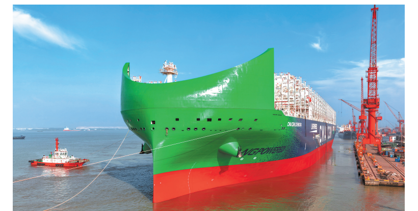
8月18日，24000TEU级超大型双燃料集装箱船“鑫福145”轮，在海事部门全程护航下，从泰兴市江苏扬子鑫福造船船坞码头安全离泊。该轮总长399.9米、型宽61.3米、型深33.5米，是全球超大型绿色环保双燃料集装箱船。
