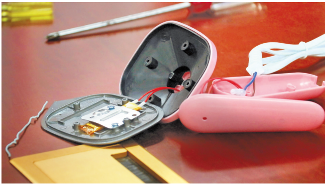
拆解开的迷你熨斗，可以看见连接导线很细，高温下表面胶皮很容易融化发生短路。
