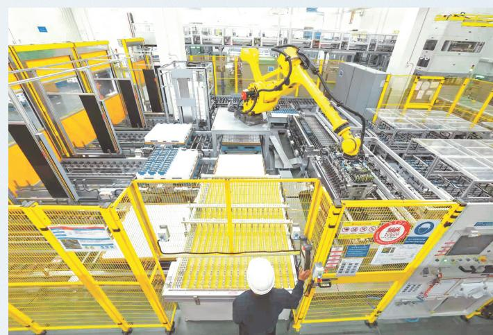
→ 在宁德时代贵州基地，从投料到成品电芯产出，生产线长达860余米，自动化率达95%，以1秒就能产出一个电芯，2.5分钟就能生产一个电池包的速度高效运转，动力电池源源不断地供给新能源产业。图为位于贵安新区的宁德时代（贵州）新能源动力及储能电池生产制造基地智能化生产线。
