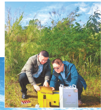
▲技术人员使用时频电磁探测设备开展物探作业。
