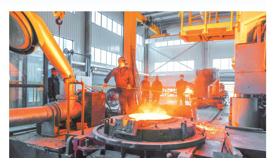
真空感应熔炼炉炼超低杂质含量高纯高温合金。
