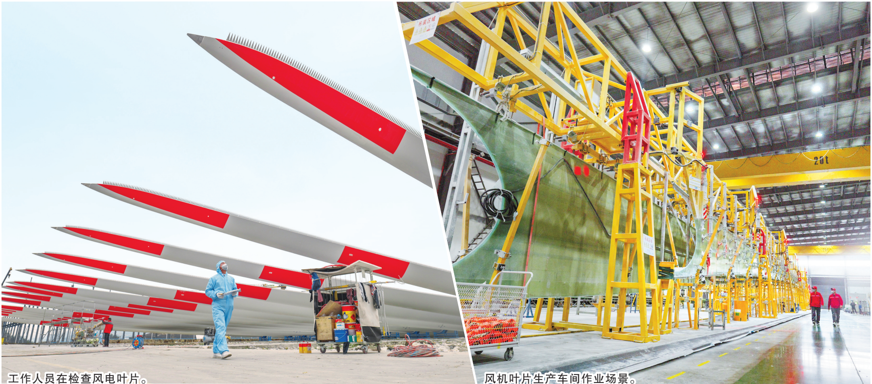
工作人员在检查风电叶片。
