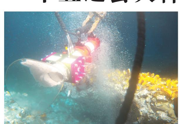
采火装置在海底冷泉喷口采集可燃冰(9月18日摄) 新华社发
