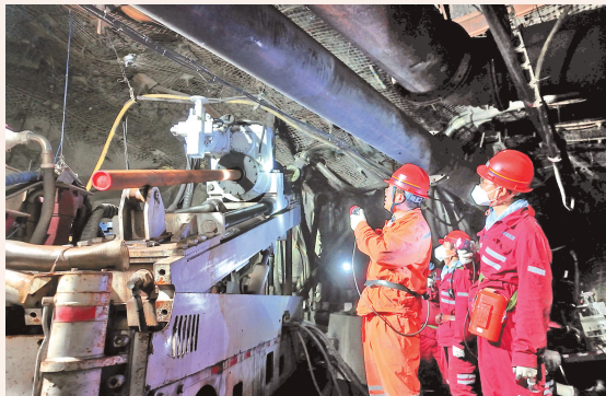
贵州理工学院矿业工程学院老师向学生介绍井下定向钻机及定向钻孔方法。
