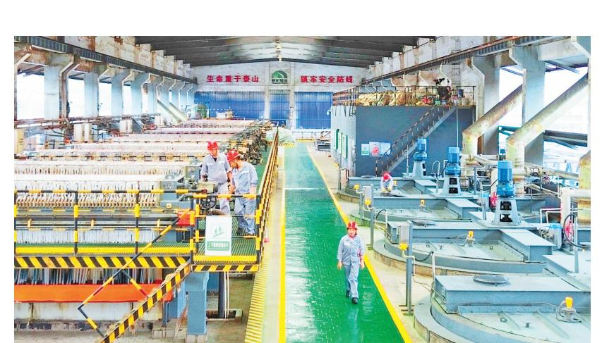
贵州能矿业集团作为开发锰资源系列产品的国企，主攻新能源电池材料生产，年产1.65万吨电解二氧化锰，产品畅销华东、华南地区，远销欧洲多国。图为8月5日，该集团生产车间工人在操作压滤机。
